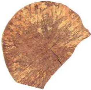
Pilt 28. Kask, läbimõõt 19 cm, 100% laomädanikku
