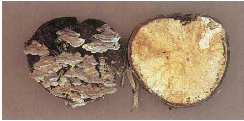
Pilt 30. Kask, läbimõõt 11 cm, 100% laomädanikku
