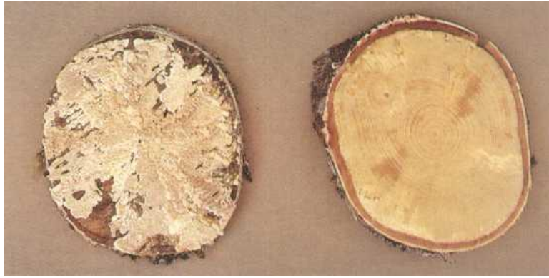
Pilt 24. Kask, läbimõõt 16 cm, 15% laomädanikku
