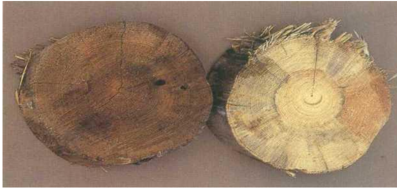
Pilt 15. Kuusk, läbimõõt 14 cm, 20% laomädanikku
