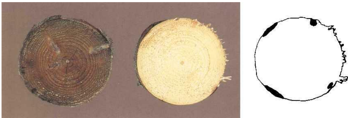
Pilt 12. Kuusk, läbimõõt 12 cm, < 5% laomädanikku
