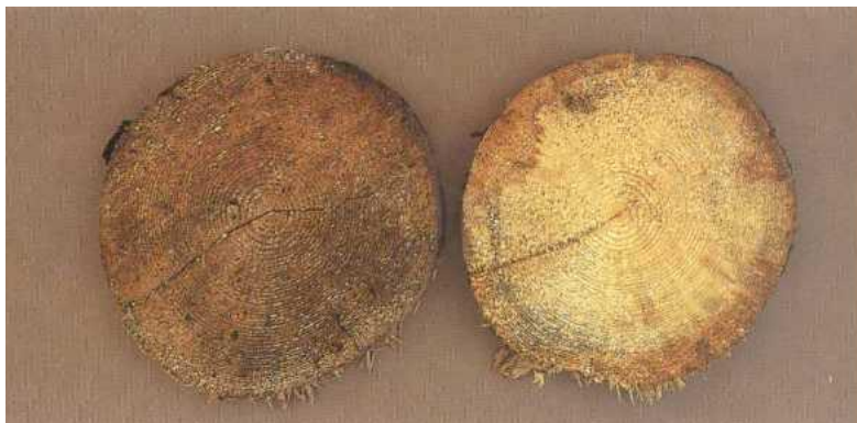
Pilt 17. Kuusk, läbimõõt 20 cm, 25% laomädanikku
