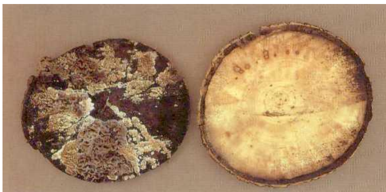
Pilt 32. Haab, läbimõõt 16 cm, 10–15% laomädanikku
