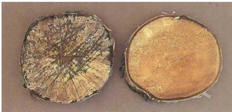
Pilt 22. Kask, läbimõõt 12 cm, < 5% laomädanikku
