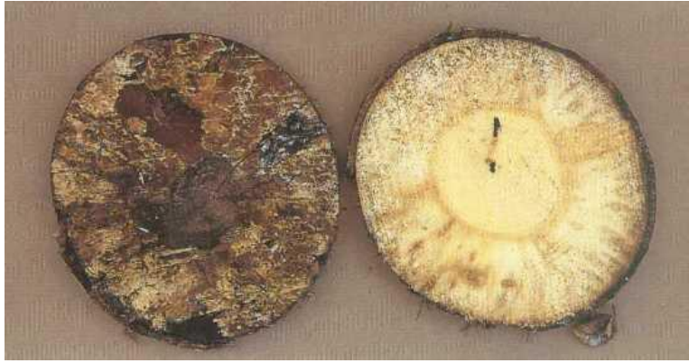
Pilt 33. Haab, läbimõõt 12 cm, 30–35% laomädanikku
