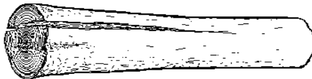
Joonis 8. Mehaaniline vigastus
