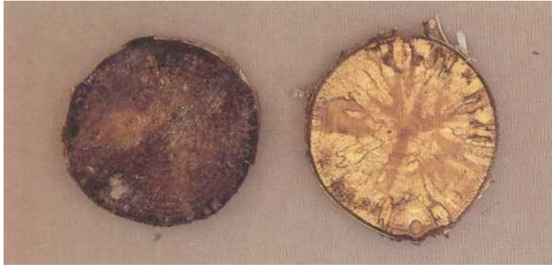
Pilt 27. Kask, läbimõõt 14 cm, 75% laomädanikku
