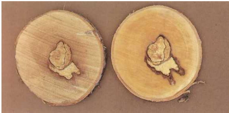
Pilt 25. Kask, läbimõõt 17 cm, 15–20% metsamädanikku
