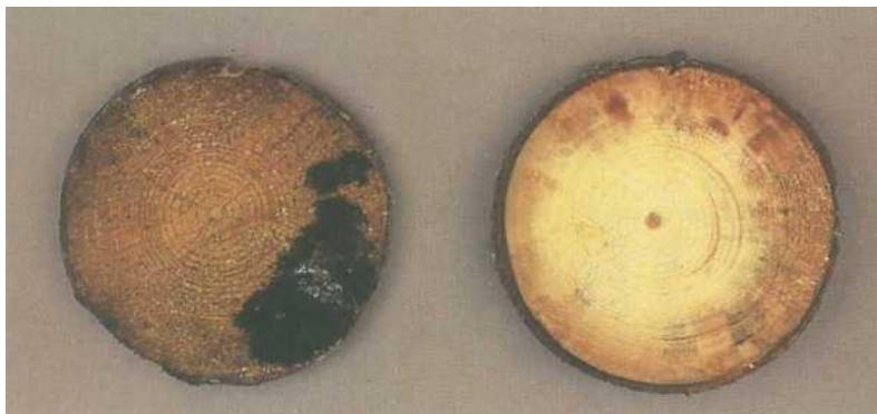
Pilt 16. Kuusk, läbimõõt 18 cm, 25–30% laomädanikku
