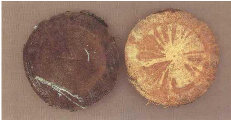
Pilt 19. Kuusk, läbimõõt 17 cm, 70% laomädanikku
