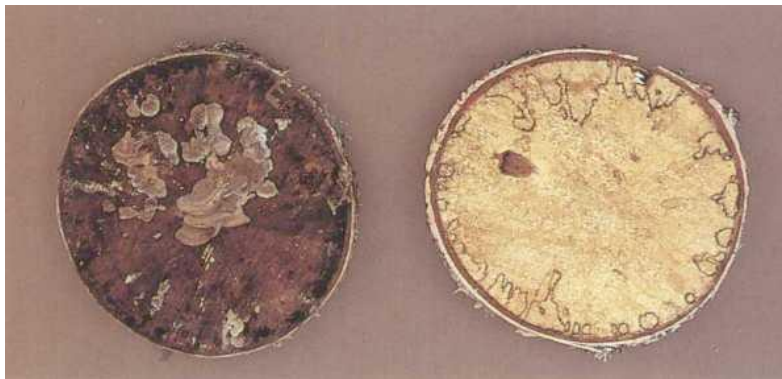
Pilt 29. Kask, läbimõõt 15 cm, 100% laomädanikku
